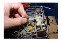
■ Alle Gummis dieser Zwischenräder wie oben beschrieben reinigen, besonders wichtig ist das größere Zwischenrad rechts unten. Ich habe den Gummi von diesem Zwischenrad abgemacht und 1 Stunde in ein Glas Spüli-Wasser eingelegt (deshalb oben rechts nicht auf dem Bild), das hat es fast in den Neuzustand zurückgebracht. Wer bei den Idler-Gummis ordentlich arbeitet, wird nachher mit einem ruhigen und trotzdem
