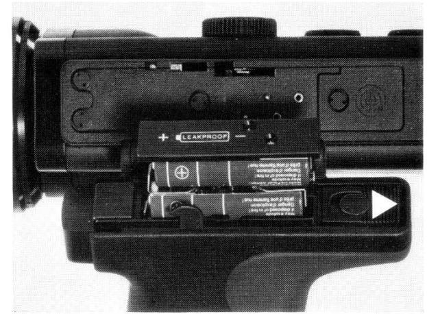
hen. Alle 6 Batterien sind mit dem Pluspol zum Pluskontakt einzusetzen. Plusmarkierung im Batteriemagazin beachten! Magazin einsetzen. Handgriff – ohne die rote Taste zu drücken – hochklappen. Bei falsch eingelegten Batterien kann die Kamera Schaden nehmen.
