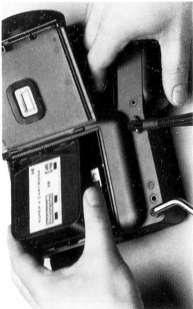
Sie können in Ihrer Kamera Super-8-Stumm- oder Tonfilmkassetten verwenden. Beim Einlegen der Kassette wird der Blenderegler automatisch auf die verwendete Filmsorte in folgenden Bereichen eingestellt:
