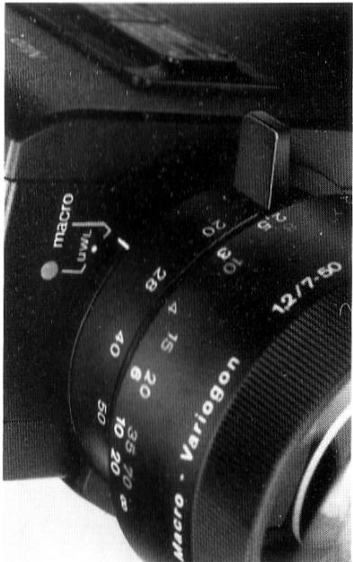
Bei Makroaufnahmen wird die Entfernung ausschließlich mit der Brennweitensteuerung entweder durch die Wipptaste (4) besser aber manuell am Brennweitenring (2) eingestellt.
