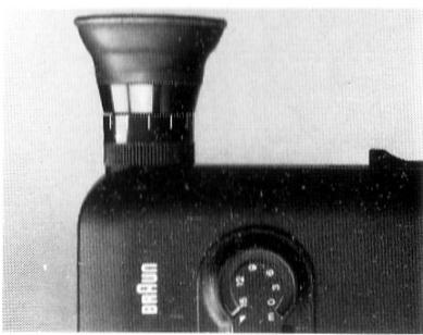
Mit dem kombinierten Haupt- und Auslöseschalter (18) schalten Sie die Stromversorgung ein und lösen die Kamera aus.
