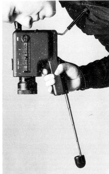
Das Teleskopmikrofon ist im Handgriff untergebracht. Es hat Richtcharakteristik.
