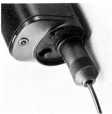
Schrauben Sie das andere Ende des Verlängerungskabels fest an das Mikrofon. Während der Aufnahme vermeiden Sie bitte Schläge gegen das Mikrofon oder dessen Kabel. Halten Sie das Mikrofon ruhig und reiben Sie es nicht.
