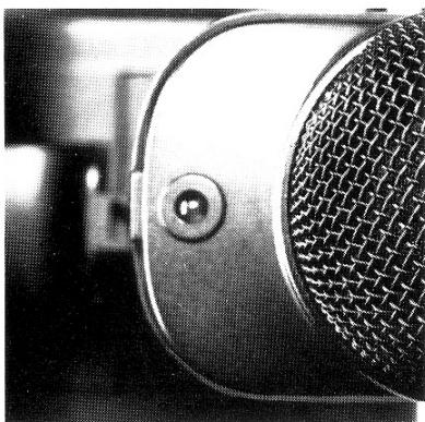
Mit dem Aktionssignal (16) wird den Akteuren vor der Kamera – z.B. bei einem Tonfilminterview – der Aufnahmebeginn und das -ende deutlich sichtbar angezeigt. Es blinkt im gleichen Rhythmus wie die Filmtransportkontrolle im Sucher.
