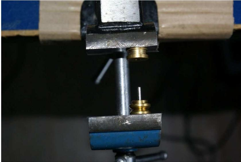
Spannen Sie nun den Rollenhalter so ein, dass die **Rückseite zum Auspress-Stift** zeigt. Dieser muss exakt auf dem heraus ragenden Stift der Rolle aufliegen, und **nur auf dem Stift** ! Die Gegenseite muss so auf der Auffanghülse aufliegen, dass sich die Austrittsöffnung des Stiftes im Bereich des Hülse-Innenlochs befindet.
