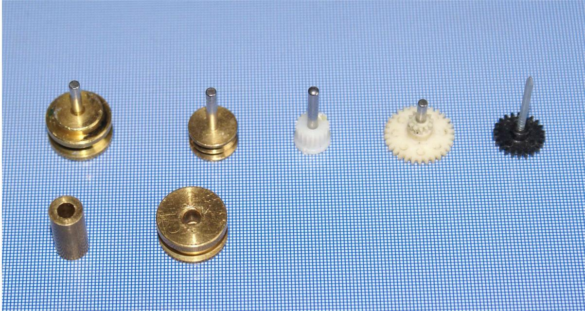
Für Rollen mit 2,5mm Innenloch (z.B. JVC KD-A5 / Saba CD-260/262/362/274, Luxman K5/K5A, NAD 6325/6100/602/614) brauchen Sie einen **2mm Auspress-Stift** von 16mm Länge.
