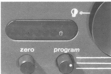
Dann drücken Sie die Zero-»0«-Taste 2 des elektronischen Zählwerks. Der Startpunkt des automatischen Toneinsatzes ist dann bildgenau programmiert.
