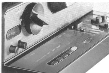
Nach Start des Projektors (Aufnahme-Betriebsart eingestellt – Aufnahmetaste gedrückt) wird nun am programmierten »0«-Durchlauf des Zählwerks die »trick«-Automatik zugeschaltet.
